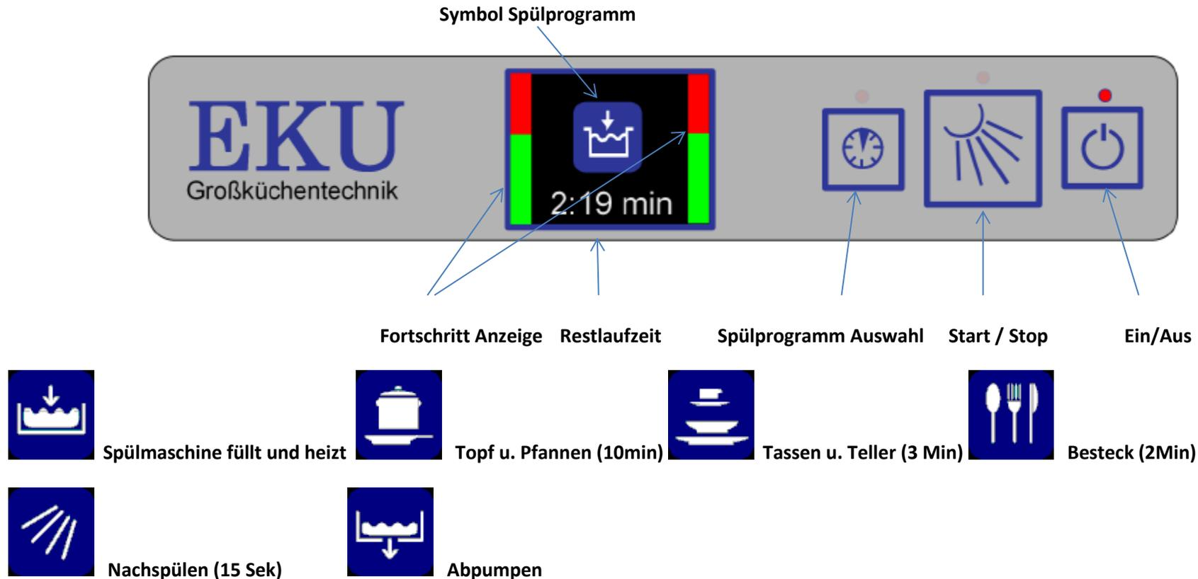
Ca. 20 Minuten vor Benutzung der Maschine einschalten ( „Lade Tank“ erscheint im Display). Maschine heizt und füllt den Tank. Sobald Fortschritt-Anzeige komplett grün leuchtet, ist die Maschine spülbereit.
